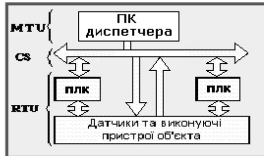
Рис. 4.15 – Склад системи SCADA
