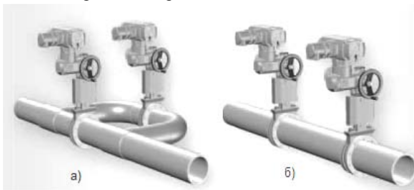
Рис. 1.3 – Системи дублювання надійного відкриття (а) та закриття (б)
